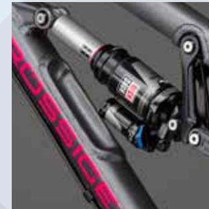
Die Ausbuchtung ermöglicht es auch Dämpfer mit größerer Luftkammer aufzunehmen.
