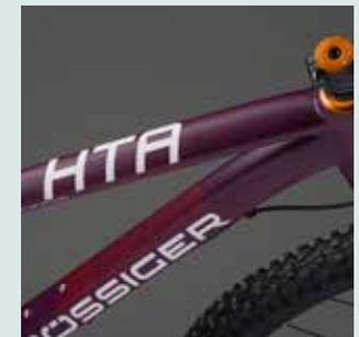
Die tiefgezogenen hydrogeformten Oberrohre ermöglichen eine niedrige Überstandshöhe.
