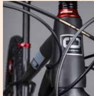
Auch unsere Carbon-Modelle verfügen über konische Steuerrohre für ein Plus an Lenkpräzision.
