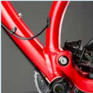
Hollow-forged 2-piece Tretlagereinheit mit Press-Fit Innenlagersitz für maximale Steifigkeit bei geringerem Gewicht.
