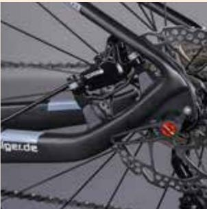
Die 12x142mm Steckachse sorgt für einen steifen Hinterbau.
