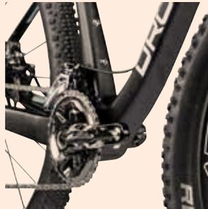
Bei den HTCs werden die Umwerfer an einer Side Swing Aufnahme befestigt.
