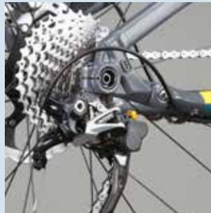
Shimano Direct-Mount Schaltwerksaufnahme für mehr Platz und einen leichteren Ein- und Ausbau des Laufrades.
