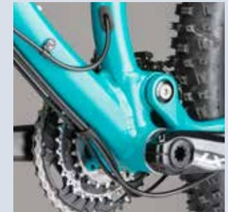
Kompatibilität zu allen absenkbaren Sattelstützen - inklusive Reverb Stealth.
