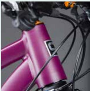
Alle HTAs verfügen über ein tapered Steuerrohr: Durch das unten vergrößerte Lager verbessert sich die Steifigkeit bei geringerem Gewicht und man erhält somit ein präziseres Lenkverhalten.
